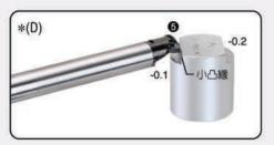
將刀尖輕靠在校正塊規的小凸緣上 8D內選用-0.1的凸緣·8D含以上 選用-0.2的凸緣
